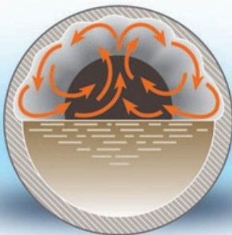
Efectos de gases emanados de la descomposición de materias orgánicas y la corrosión en tuberías de concreto
